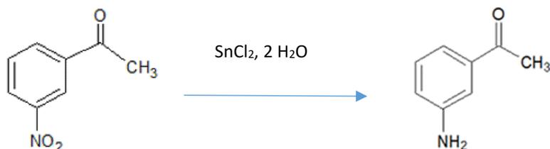
Le chlorure d'étain est un réactif chimiosélectif car il ne réagit qu'avec une fonction sur les deux possibles.
